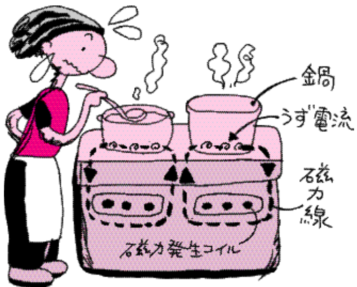
IH式電磁調理器の仕組み
